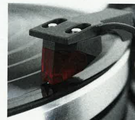
Tonabnehmer. Er hält die Nadel und wandelt die mechanischen Schwingungen in elektrische Spannungen um.
