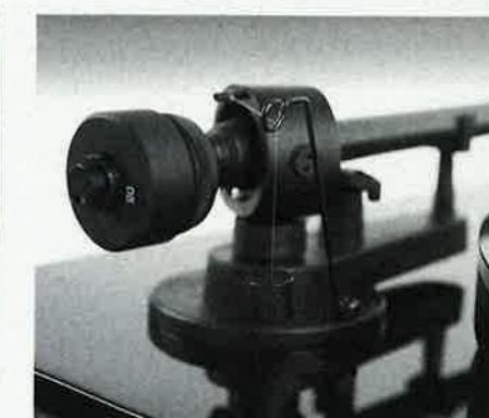
Tonarm. Ein Gegengewicht und ein Anti-skating-System am Tonarmende sorgen dafür, dass die Nadel optimal aufliegt.
